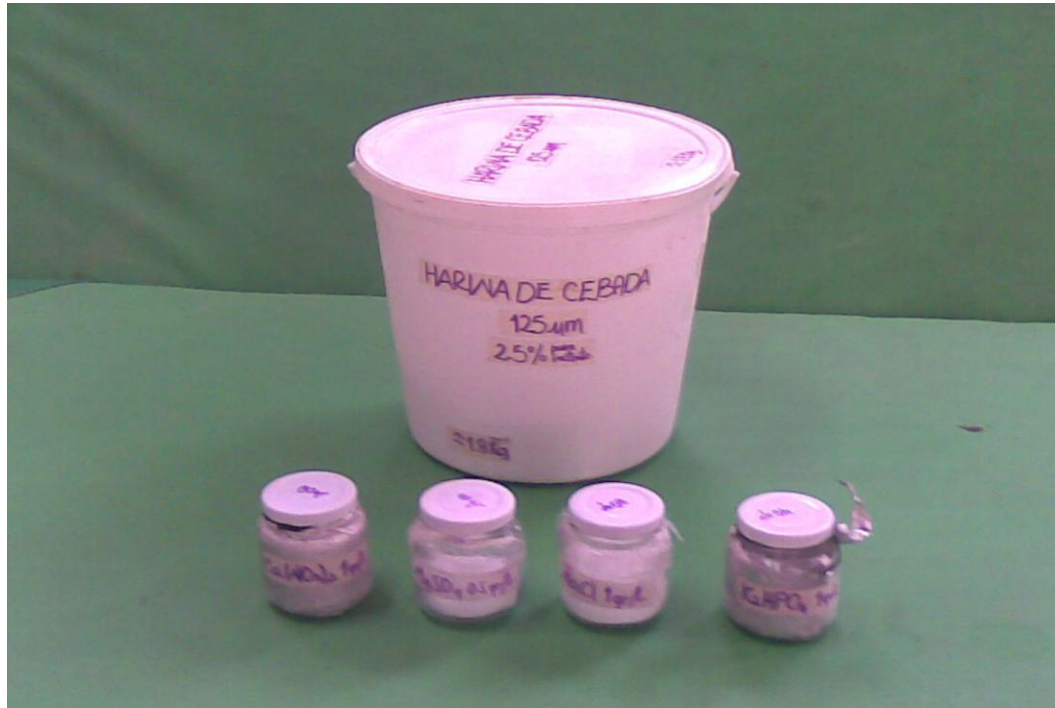
Foto 15. Componentes para la preparación de sustratos foliares (harina de cebada + K_2HPO_4 + NaCl)
