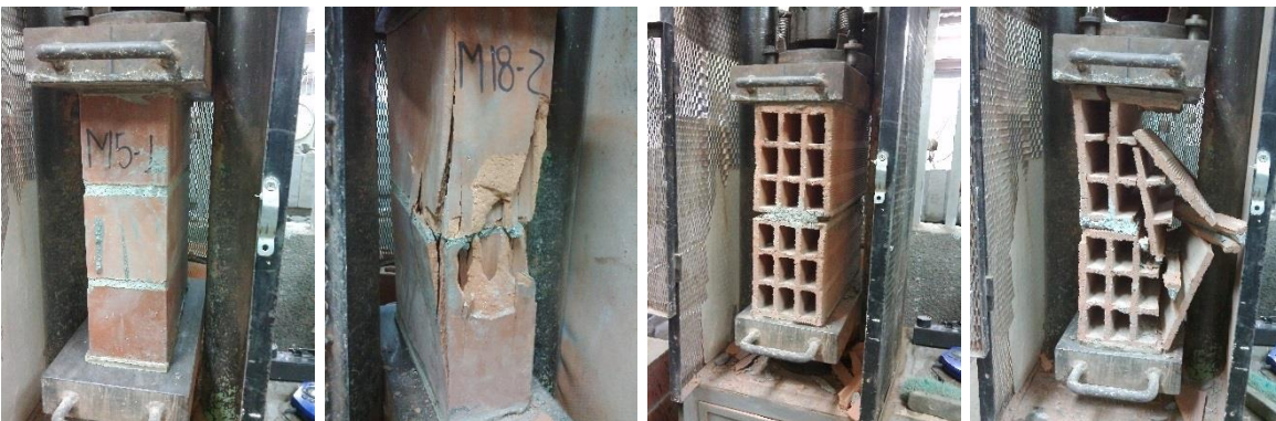
Foto 6. Ensayo a compresión de muretes.
