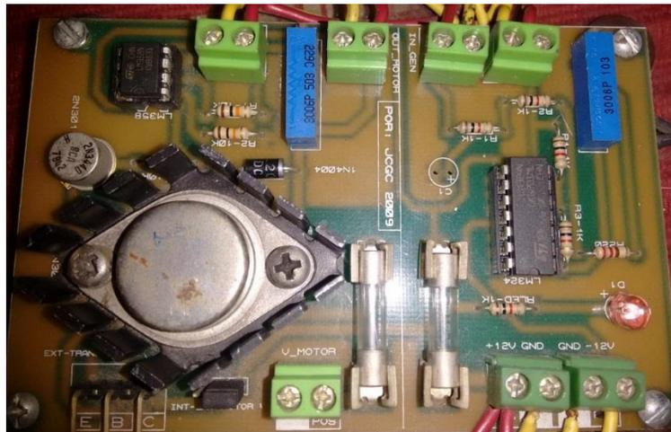
Figura 2.2 Tarjeta de salida o de potencia
