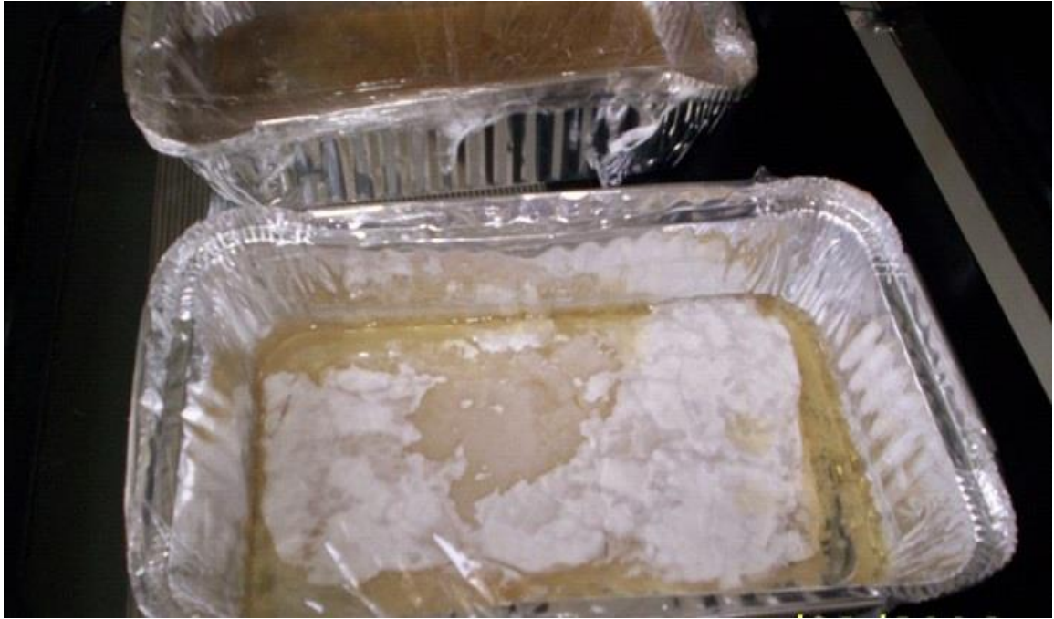
Figura 3. Bandeja con B. bassiana cultivado en medio 3. Se observa formación de grumos y distribución no uniforme del micelio.
